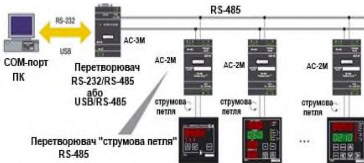
Рис. 23 – Схема підключення пристроїв з інтерфейсом «струмова петля» до ПК
