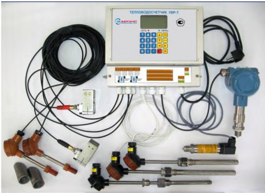
Рис. 5 Загальний вигляд тепловодолічильника УБР-ТМ2
